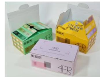
▲高精密フレキシ印刷機を使って印刷した配送段ボール
